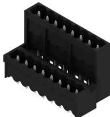
Connecteurs mâles fermés, résistant aux hautes températures, double étage, avec décalage latéral, en option avec brides à souder. Picot de 1,5 mm adapté à la soudure par refusion. Picots de 3,2 mm adaptés à la soudure à la vague et par refusion. Ils peuvent être repérés et codés.
