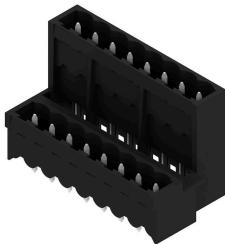
Connecteurs mâles fermés, résistant aux hautes températures, double étage, avec décalage latéral, en option avec brides à souder. Picot de 1,5 mm adapté à la soudure par refusion. Picots de 3,2 mm adaptés à la soudure à la vague et par refusion. Ils peuvent être repérés et codés.
