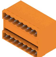
Connecteur mâle avec enfichage parallèle. La longueur des picots est optimisée pour la soudure à la vague. Ils peuvent être repérés et codés.
