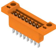
Connecteurs de passage mâle pour montage face-avant avec fonction de verrouillage. Le raccordement interne est un raccordement à languette ou soudé. Les connecteurs mâles peuvent être repérés et détrompés.
