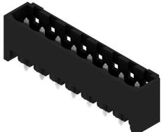
Connecteur mâle résistant aux températures élevées, avec conditionnement en boîte ou en rouleau. En rouleau, avec picot à souder 1,5 mm, optimisé pour l'implantation automatique. Longueurs de picots de 3,2 mm indiquées pour les applications de soudure à la vague et par refusion. Les connecteurs mâles disposent d'espace pour les marquages et peuvent être codés. HC = Courant fort.
