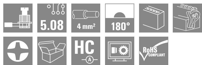
Connecteur femelle avec raccordement à vis à étrier pour le raccordement de conducteurs à orientation de sortie droite (180°). Les connecteurs femelle disposent d'espace pour les marquages et peuvent être codés. Fixation par bride ou par levier de verrouillage. Ils disposent également d'une vis plus/moins intégrée et d'une protection contre toute mauvaise insertion du connecteur. Ils sont livrés avec étriers ouverts. HC = Courant fort.
