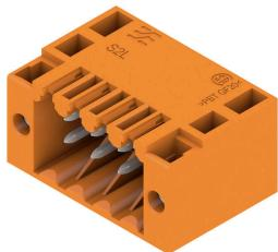
Connecteurs mâles double rangée, coudés, en version avec extrémités latérales fermées ou avec brides (extrémités latérales fermées sur demande). Les connecteurs mâles avec longueur de picot de 3,5 mm sont conçus pour la soudure à la vague et conditionnés en boîte. Il est possible de les visser sur circuit imprimé. Ils peuvent être repérés et codés.
