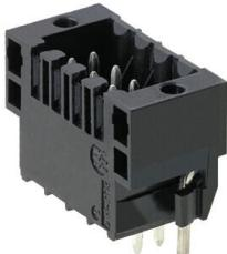
Connecteur mâle résistant aux températures élevées, double rangée, pour tous les systèmes de soudure usuels. Optimisés pour l'implantation automatique. Conditionnement en boîte ou en rouleau. Longueurs de picots de 3,2 mm indiquées pour les applications de soudure à la vague et par refusion. Les connecteurs mâles disposent d'espace pour les marquages et peuvent être codés.
