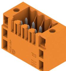
Connecteur mâle droit double rangée disponible en version avec extrémités latérales fermées ou avec brides (extrémités latérales ouvertes sur demande). Les connecteurs mâles avec une longueur de picot de 3,5 mm sont conçus pour la soudure à la vague et sont conditionnés en boîte. Ils peuvent être vissés sur le circuit imprimé. Les connecteurs mâles disposent d'espace pour les marquages et peuvent être codés.
