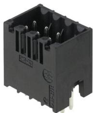
Connecteur mâle résistant aux températures élevées, double rangée, pour tous les systèmes de soudure usuels. Optimisés pour l'implantation automatique. Conditionnement en boîte ou en rouleau. Longueurs de picots de 3,2 mm indiquées pour les applications de soudure à la vague et par refusion. Les connecteurs mâles disposent d'espace pour les marquages et peuvent être codés.
