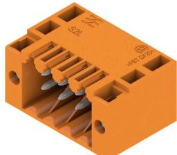
Connecteurs mâles double rangée, coudés, en version avec extrémités latérales fermées ou avec brides (extrémités latérales fermées sur demande). Les connecteurs mâles avec longueur de picot de 3,5 mm sont conçus pour la soudure à la vague et conditionnés en boîte. Il est possible de les visser sur circuit imprimé. Ils peuvent être repérés et codés.
