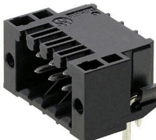
Connecteurs mâles double rangée droits, résistants aux hautes températures, pour tous process de soudure. Optimisés pour l'implantation automatique. Conditionnement en boîte ou en rouleau. Picots de 3,2 mm adaptés à la soudure à la vague et par refusion. Ils peuvent être codés et repérés.
