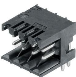
Connecteurs mâles double rangée droits, résistants aux hautes températures, pour tous process de soudure. Optimisés pour l'implantation automatique. Conditionnement en boîte ou en rouleau. Picots de 3,2 mm adaptés à la soudure à la vague et par refusion. Ils peuvent être codés et repérés. (conditionnement en bande sur demande)
