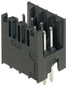
Connecteur mâle résistant aux températures élevées, double rangée, pour tous les systèmes de soudure usuels. Optimisés pour l'implantation automatique. Conditionnement en boîte ou en rouleau. Longueurs de picots de 3,2 mm indiquées pour les applications de soudure à la vague et par refusion. Les connecteurs mâles disposent d'espace pour les marquages et peuvent être codés.
