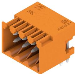
Connecteurs mâles double rangée, coudés, en version avec extrémités latérales fermées ou avec brides (extrémités latérales fermées sur demande). Les connecteurs mâles avec longueur de picot de 3,5 mm sont conçus pour la soudure à la vague et conditionnés en boîte. Il est possible de les visser sur circuit imprimé. Ils peuvent être repérés et codés.
