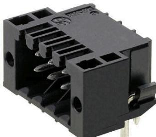
Connecteurs mâles double rangée droits, résistants aux hautes températures, pour tous process de soudure. Optimisés pour l'implantation automatique. Conditionnement en boîte ou en rouleau. Picots de 3,2 mm adaptés à la soudure à la vague et par refusion. Ils peuvent être codés et repérés.
