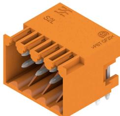
Connecteurs mâles double rangée, coudés, en version avec extrémités latérales fermées ou avec brides (extrémités latérales fermées sur demande). Les connecteurs mâles avec longueur de picot de 3,5 mm sont conçus pour la soudure à la vague et conditionnés en boîte. Il est possible de les visser sur circuit imprimé. Ils peuvent être repérés et codés.
