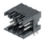
Connecteurs mâles double rangée droits, résistants aux hautes températures, pour tous process de soudure. Optimisés pour l'implantation automatique. Conditionnement en boîte ou en rouleau. Picots de 3,2 mm adaptés à la soudure à la vague et par refusion. Ils peuvent être codés et repérés.
