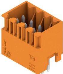
Connecteur mâle droit double rangée disponible en version avec extrémités latérales fermées ou avec brides (extrémités latérales ouvertes sur demande). Les connecteurs mâles avec une longueur de picot de 3,5 mm sont conçus pour la soudure à la vague et sont conditionnés en boîte. Ils peuvent être vissés sur le circuit imprimé. Les connecteurs mâles disposent d'espace pour les marquages et peuvent être codés.
