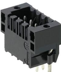
Connecteur mâle résistant aux températures élevées, double rangée, pour tous les systèmes de soudure usuels. Optimisés pour l'implantation automatique. Conditionnement en boîte ou en rouleau. Longueurs de picots de 3,2 mm indiquées pour les applications de soudure à la vague et par refusion. Les connecteurs mâles disposent d'espace pour les marquages et peuvent être codés.
