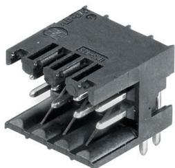
Connecteurs mâles double rangée droits, résistants aux hautes températures, pour tous process de soudure. Optimisés pour l'implantation automatique. Conditionnement en boîte ou en rouleau. Picots de 3,2 mm adaptés à la soudure à la vague et par refusion. Ils peuvent être codés et repérés. (conditionnement en bande sur demande)
