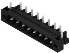
Connecteur mâle ouvert, droit, résistant aux hautes températures Conditionnement en boîte ou en rouleau. En rouleau, avec picot à souder 1,5 mm, optimisé pour l'implantation automatique. Longueurs de picots de 3,2 mm indiquées pour les applications de soudure à la vague et par refusion. Les connecteurs mâles disposent d'espace pour les marquages et peuvent être codés. HC = Courant fort.
