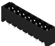
Connecteur mâle résistant aux températures élevées, avec conditionnement en boîte ou en rouleau. En rouleau, avec picot à souder 1,5 mm, optimisé pour l'implantation automatique. Longueurs de picots de 3,2 mm indiquées pour les applications de soudure à la vague et par refusion. Les connecteurs mâles disposent d'espace pour les marquages et peuvent être codés. HC = Courant fort.
