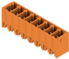
Le connecteur mâle SC présente un sens d'enfichage perpendiculaire au circuit imprimé (debout) et est disponible en version fermée (G) et avec brides à visser (F). Le layout des connecteurs enfichables à pas de 3,81 mm (0,15 pouces) de Weidmüller est compatible avec les connecteurs enfichables courants et laisse de la place pour l'impression et le codage.
