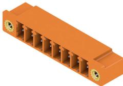
Le connecteur mâle SC présente un sens d'enfichage parallèle au circuit imprimé (couché) et est disponible en version fermée (G) et avec brides à visser (F). Le layout des connecteurs enfichables à pas de 3,81 mm (0.15 pouces) de Weidmüller est compatible avec les connecteurs enfichables courants, laisse une place pour l'impression et le codage, de même qu'un logement pour un Indicateur par guides de lumière.
