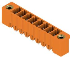
Le connecteur mâle SC présente un sens d#92enfichage perpendiculaire au circuit imprimé (debout) et est disponible en version fermée (G) et avec brides à visser (F). Le layout des connecteurs enfichables à pas de 3,81 mm (0.15 pouces) de Weidmüller est compatible avec les connecteurs enfichables courants et laisse de la place pour l#92impression et le codage.
