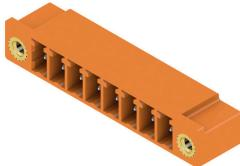
Le connecteur mâle SC présente un sens d#92enfichage parallèle au circuit imprimé (couché) et est disponible en version fermée (G) et avec brides à visser (F). Le layout des connecteurs enfichables à pas de 3,81 mm (0.15 pouces) de Weidmüller est compatible avec les connecteurs enfichables courants, laisse une place pour l#92impression et le codage, de même qu'un logement pour un Indicateur par guides de lumière.
