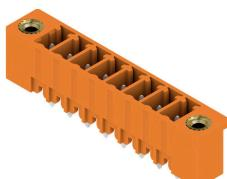
Le connecteur mâle SC présente un sens d'enfichage perpendiculaire au circuit imprimé (debout) et est disponible en version fermée (G) et avec brides à visser (F). Le layout des connecteurs enfichables à pas de 3,81 mm (0.15 pouces) de Weidmüller est compatible avec les connecteurs enfichables courants et laisse de la place pour l'impression et le codage.
