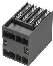
Connecteur mâle double rangée hautes performances pour courants élevés, avec ou sans bride, pour un verrouillage rapide et sans outil. Optimisé pour les modules mesurant 50 mm de large et plus. Avec option de montage intégrée pour un montage sur les parois du boîtier. Fiabilité et sécurité de fonctionnement exceptionnelles grâce à la face d'enfichage intégrée 100 % sûre, au codage unique et à la fixation à vis supplémentaire optionnelle sur la bride.
