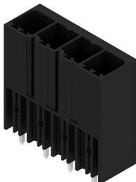
Connecteur mâle puissant monorangée, juxtaposable sans perte de pôles ou avec système de brides breveté pour verrouillage rapide et sans outil. Fiabilité de raccordement et de fonctionnement maximale grâce à une face d'enfichage qui empêche tout raccordement erroné, avec une diversité de codage unique, fixations supplémentaires de la bride. Longueur des picots 3,5 mm optimisée pour la soudure à la vague sans plomb.
