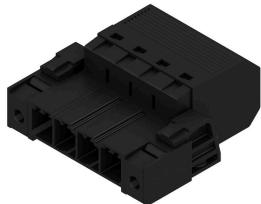
Connecteur mâle inversé à 180° avec raccordement PUSH IN pour câblage de terrain 6 mm<sup>2</sup> au pas de 7,62, réalisant une « version à trois brides » pour les blocs de jonction de traversée de boîtier. Convient aux boîtier dont l'épaisseur de paroi ne dépasse pas 2 mm. Convient en outre idéalement comme solution de protection des doigts pour tensions inverses. Satisfait les exigences des normes UL1059 600 V classe C et CEI 61800-5-1.
