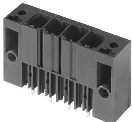
Connecteur mâle puissant monorangée, juxtaposable sans perte de pôles ou avec système de brides breveté pour verrouillage rapide et sans outil. Fiabilité de raccordement et de fonctionnement maximale grâce à une face d'enfichage qui empêche tout raccordement erroné, avec une diversité de codage unique, fixations supplémentaires de la bride. Longueur des picots 3,5 mm optimisée pour la soudure à la vague sans plomb.
