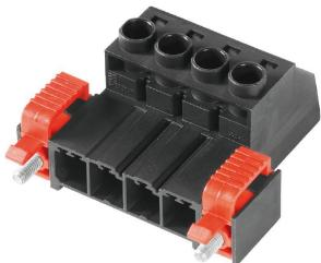
Connecteur mâle puissant avec l'étrier en acier éprouvé de Weidmüller, 100 % sans maintenance. Installation côte-à-côte sans perte de pôles ou avec système de brides multifonction breveté pour un verrouillage sûr, rapide et sans outils. Fiabilité de raccordement et de fonctionnement maximale grâce à une face d'enfichage qui empêche tout raccordement erroné, une diversité de codage unique, une protection contre les mauvais câblages. Permet un repérage.
