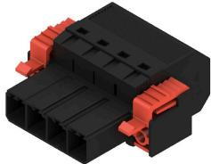
Connecteur mâle inversé à 180° avec raccordement PUSH-IN pour câblage de terrain 6 mm<sup>2</sup> avec brides extérieures inversées, au pas de 7,62. En plus, convient idéalement comme solution de protection des doigts pour tensions inverses. Satisfait les exigences des normes UL1059 600 V classe C et CEI 61800-5-1. Également disponible en option en version vissable et sans bride.
