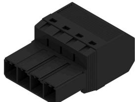
Connecteur mâle inversé à 180° avec raccordement PUSH IN pour câblage de terrain 6 mm<sup>2</sup> au pas de 7,62, réalisant une « version à trois brides » pour les blocs de jonction de traversée de boîtier. Convient aux boîtiers dont l'épaisseur de paroi ne dépasse pas 2 mm. Convient en outre idéalement comme solution de protection des doigts pour tensions inverses. Satisfait les exigences des normes UL1059 600 V classe C et CEI 61800-5-1.
