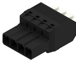
Connecteur mâle inversé à 180° avec raccordement PUSH IN et actionneur réglable (poussoir) pour câblage de terrain 6 mm<sup>2</sup> au pas de 7,62. Convient en outre idéalement comme solution de protection des doigts pour tensions inverses. Satisfait les exigences des normes UL1059 600 V classe C et CEI 61800-5-1. Versions : sans bride, bride externe, bride centrale avec mécanisme enclipsable, et, en option, vis de montage supplémentaire.
