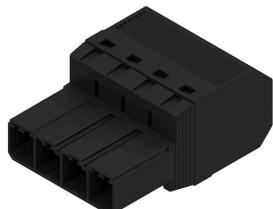
Connecteur mâle inversé à 180° avec raccordement PUSH IN pour câblage de terrain 6 mm<sup>2</sup> au pas de 7,62, réalisant une « version à trois brides » pour les blocs de jonction de traversée de boîtier. Convient aux boîtiers dont l'épaisseur de paroi ne dépasse pas 2 mm. Convient en outre idéalement comme solution de protection des doigts pour tensions inverses. Satisfait les exigences des normes UL1059 600 V classe C et CEI 61800-5-1.
