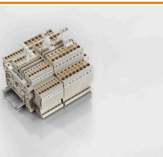
SnapMark - ce support de repérage a été développé spécialement pour les blocs de jonction double étage IDK 1.5N série I. Grâce au mécanisme articulé basculant, les connexions transversales peuvent être montées et enlevées sans problème. Il peut accueillir quatre repères DEK 5 ou deux repères de blocs de jonction WS 10/5 Middle.
