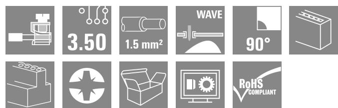
Bloc de jonction pour circuit imprimé très petit et compact au pas de 3,5 mm, avec sortie de fil à 90°. Section jusqu'à 1,5 mm<sup>2</sup>.
