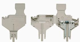
La fiche avec composant est utilisée pour intégrer des composants électrique dans un bloc de jonction sectionnable. Après avoir soudé les composants électroniques, le mâle peut être intégré dans la zone de déconnexion de nos blocs de jonction sectionnable et change ainsi le bloc de jonction sectionnable en bloc de jonction modulaire avec composants électroniques intégrés.
