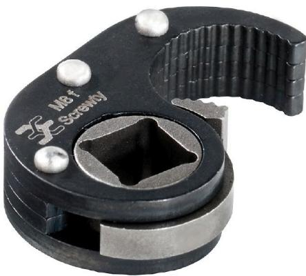
Les accessoires Screwty® sont indiqués pour les connecteurs débrochables ronds M8 à équiper, avec une dimension extérieure du moletage de  $11,9 \pm 0,3$  mm. Le couple de raccordement est de 0,5-0,6 Nm.
