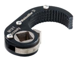
Les accessoires Screwty® sont indiqués pour les connecteurs débrochables ronds M12 à équiper, avec une dimension extérieure du moletage de 19,8  $\pm$ 0,3 mm. Le couple de raccordement est de 0,8-1,2 Nm.
