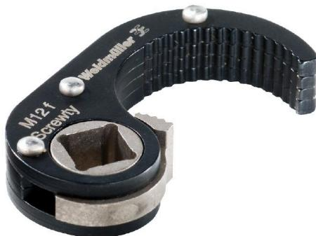
Les accessoires Screwty® sont indiqués pour les connecteurs débrochables ronds M12 à équiper, avec une dimension extérieure du moletage de  $19,8 \pm 0,3$  mm. Le couple de raccordement est de 0,8-1,2 Nm.
