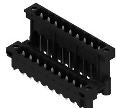
Connecteurs mâles résistants aux hautes températures, à double étage, disposés latéralement, avec bride ou bride à souder. Picot à souder de 1,5 mm valable pour les applications de soudure par refusion. Picots de 3,2 mm adaptés à la soudure à la vague et par refusion. Ils peuvent être repérés et codés.
