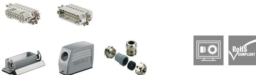
Les kits RockStar® se composent en règle générale d'un insert mâle, d'un insert femelle, d'un boîtier de connecteur, d'une embase encastrée et d'un presse-étoupe. Weidmüller vous propose un assortiment de combinaisons de connecteurs débrochables courants avec des filetages d'entrée de câbles PG ou métriques, avec raccordement à vis ou PUSH IN.
