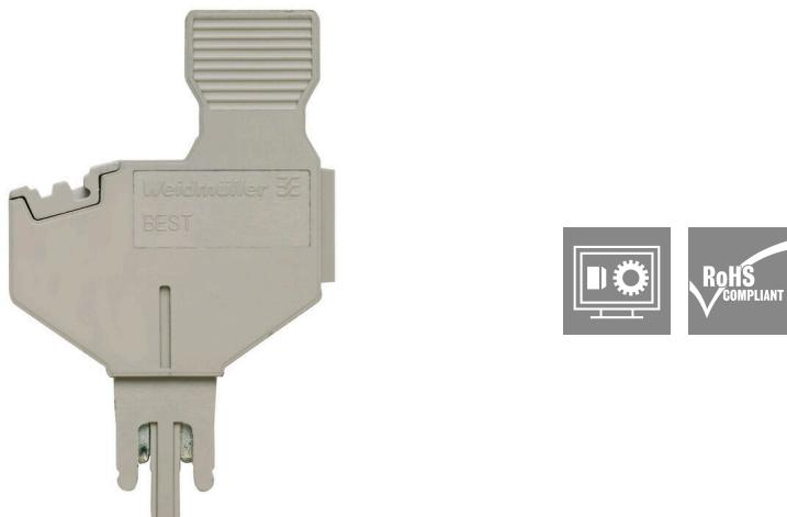
La fiche avec composant est utilisée pour intégrer des composants électrique dans un bloc de jonction sectionnable. Après avoir soudé les composants électroniques, le mâle peut être intégré dans la zone de déconnexion de nos blocs de jonction sectionnable et change ainsi le bloc de jonction sectionnable en bloc de jonction modulaire avec composants électroniques intégrés.
