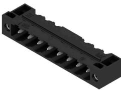
Connecteur mâle résistant aux températures élevées, avec conditionnement en boîte ou en rouleau. En rouleau, avec picot à souder 1,5 mm, optimisé pour l'implantation automatique. Longueurs de picots de 3,2 mm indiquées pour les applications de soudure à la vague et par refusion. Les connecteurs mâles disposent d'espace pour les marquages et peuvent être codés. HC = Courant fort.
