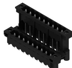
Connecteurs mâles résistants aux hautes températures, à double étage, disposés latéralement, avec bride ou bride à souder. Picot à souder de 1,5 mm valable pour les applications de soudure par refusion. Picots de 3,2 mm adaptés à la soudure à la vague et par refusion. Ils peuvent être repérés et codés.
