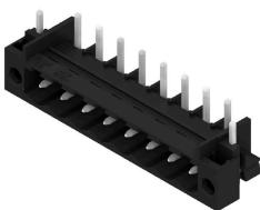
Connecteur mâle ouvert, droit, résistant aux hautes températures Conditionnement en boîte ou en rouleau. En rouleau, avec picot à souder 1,5 mm, optimisé pour l'implantation automatique. Longueurs de picots de 3,2 mm indiquées pour les applications de soudure à la vague et par refusion. Les connecteurs mâles disposent d'espace pour les marquages et peuvent être codés. HC = Courant fort.
