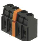
La tension maximale dépend de la distance minimale. Les plaques intermédiaires augmentent les lignes d'air et de fuite entre les différents potentiels et permettent des tensions nominales plus élevées ou une séparation nette, par exemple entre le secteur et les tensions basses ou différentes zones de protection.
