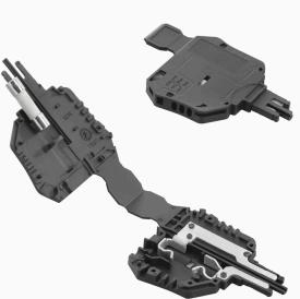
Le support fusible SIHA permet de transformer en un tour de main un bloc de jonction sectionnable en bloc de jonction à fusible : il suffit simplement de remplacer le levier de sectionnement par une fiche fusible.
