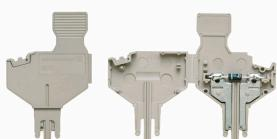
La fiche avec composant est utilisée pour intégrer des composants électrique dans un bloc de jonction sectionnable. Après avoir soudé les composants électriques, le mâle peut être intégré dans la zone de déconnexion de nos blocs de jonction sectionnable et change ainsi le bloc de jonction sectionnable en bloc de jonction modulaire avec composants électriques intégrés.
