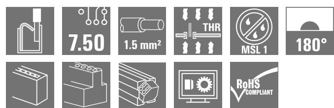
Bloc de jonction pour circuit imprimé pour implantation automatique dans les process de refusion (CMS), avec technique de raccordement du conducteur Push In. Insertion du conducteur et coulisement de la glissière dans la même direction (TOP). Conditionnement en boîte ou en Tape-on-Reel. Longueurs de picot optimisées à 1,5 mm ou 3,5 mm.
