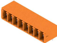
Le connecteur mâle SC présente un sens d#92enfichage parallèle au circuit imprimé (couché) et est disponible en version fermée (G) et avec brides à visser (F). Le layout des connecteurs enfichables à pas de 3,81 mm (0.15 pouces) de Weidmüller est compatible avec les connecteurs enfichables courants, laisse une place pour l#92impression et le codage, de même qu'un logement pour un Indicateur par guides de lumière.
