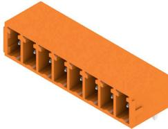
Le connecteur mâle SC présente un sens d'enfichage parallèle au circuit imprimé (couché) et est disponible en version fermée (G) et avec brides à visser (F). Le layout des connecteurs enfichables à pas de 3,81 mm (0,15 pouces) de Weidmüller est compatible avec les connecteurs enfichables courants, laisse une place pour l'impression et le codage, de même qu'un logement pour un Indicateur par guides de lumière.
