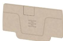
Les flasques de fermeture sont placées à l'extrémité ouverte du bornier, avant l'équerre de blocage. L'utilisation des flasques de fermeture permet de conserver les caractéristiques des blocs de jonction comme par exemple la tension nominale. On évite ainsi le contact avec les pièces sous tension et le dernier bloc de jonction est protégé contre l'accès des doigts .
