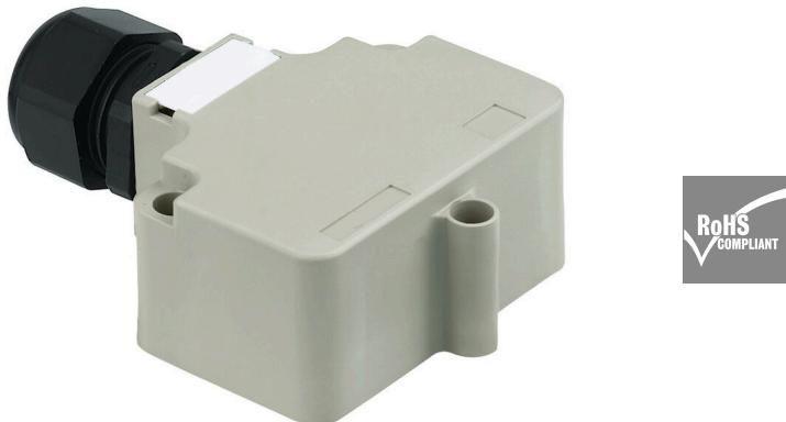
Les répartiteurs M12 sont proposés dans de très nombreuses versions. Les 4, 6 ou 8 connecteurs M12 disposent de 4 ou 5 pôles. La sortie principale se présente sous forme de câble fixe, de capot à raccorder soi-même ou de M23. Il existe par ailleurs d'autres versions particulières. Il existe par exemple un répartiteur 1 : 1 permettant de choisir librement le raccordement ou des répartiteurs homologués Ex Zone 1.
