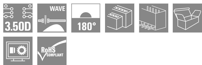
Connecteur mâle droit double rangée disponible en version avec extrémités latérales fermées ou avec brides (extrémités latérales ouvertes sur demande). Les connecteurs mâles avec une longueur de picot de 3,5 mm sont conçus pour la soudure à la vague et sont conditionnés en boîte. Ils peuvent être vissés sur le circuit imprimé. Les connecteurs mâles disposent d'espace pour les marquages et peuvent être codés.
