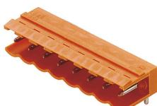
Connecteurs mâles avec sortie à 90°. La longueur des picots est optimisée pour la soudure à la vague. Ils peuvent être repérés et codés.
