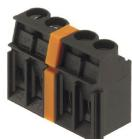
La tension maximale dépend de la distance minimale. Les plaques intermédiaires augmentent les lignes d'air et de fuite entre les différents potentiels et permettent des tensions nominales plus élevées ou une séparation nette, par exemple entre le secteur et les tensions basses ou différentes zones de protection.
