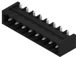
Connecteur mâle ouvert, droit, résistant aux hautes températures. Conditionnement en boîte ou en rouleau. En rouleau, avec picot à souder 1,5 mm, optimisé pour l'implantation automatique. Longueurs de picots de 3,2 mm indiquées pour les applications de soudure à la vague et par refusion. Les connecteurs mâles disposent d'espace pour les marquages et peuvent être codés. HC = Courant fort.
