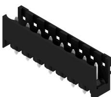
Connecteur mâle ouvert, droit, résistant aux hautes températures Conditionnement en boîte ou en rouleau. En rouleau, avec picot à souder 1,5 mm, optimisé pour l'implantation automatique. Longueurs de picots de 3,2 mm indiquées pour les applications de soudure à la vague et par refusion. Les connecteurs mâles disposent d'espace pour les marquages et peuvent être codés. HC = Courant fort.
